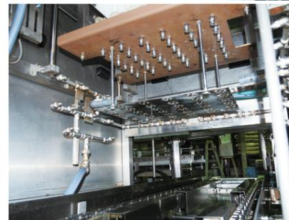
ノズルは簡単に脱着が可能。平野豆富製造所では、ノズルを外して、すまし粉凝固にも使用。別チューブからすまし粉を注入し、36カ所の穴抜きされた攪拌板で攪拌される。
