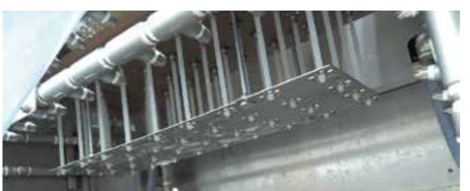
↑突き出た36本のノズル。ノズル1本につき7カ所の噴射口がある(36×7=計252カ所)。それが、高温豆乳が入られた型箱に向かって降ろされていく。攪拌板が型箱の底まで降りる間に、252カ所から一斉に天然にがり噴射。凝固時間、わずか1.2秒。「高温一発寄せ」を機械で実現させている。
