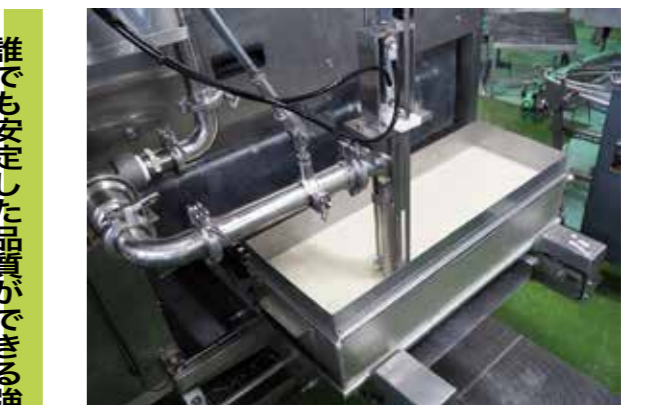
幅が広い型箱でも全体にムラなく安定した凝固ができる
